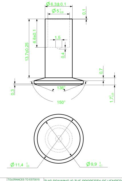
MATERIAL SPEC: BRASS PLATED STEEL C-1008 (LIME FINISH WIRE QUALITY **BRIGHT SHEROIDIZED ANNEALED)**
